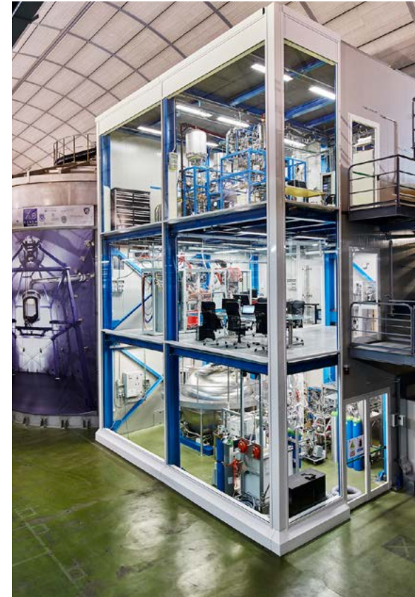
وتتضمن البنية التحتية المشيدة تحت الأرض لكاشف XENONIT خزناً مائياً وترموسنات لتنظيم الحرارة المنخفضة ومجموعة من الأجهزة الإلكترونية وخزان غازي ومعدات لتنقية المياه.
